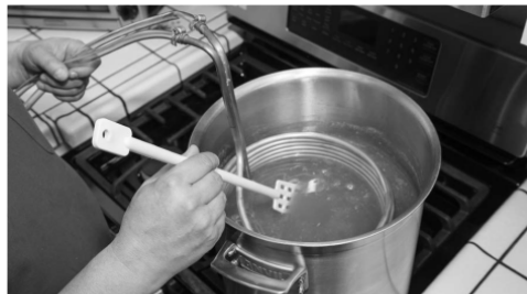
Ryc. 1.13 Chłodnica zanurzeniowa umieszczona w kotle z wrzącą brzeczka
