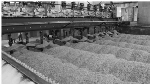
Ryc. 15.3 Po namaczeniu słód jest przenoszony do komory kiełkowania, gdzie przez kilka dni napowietrza się go i przewraca, żeby uzyskać jednolity stopień wzrostu. Słód spędza tam około czterech dni, po czym przechodzi do komory suszenia. (Fotografia zamieszczona za zgodą Briess Malt & Ingredients Co.)
