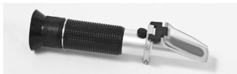
Ryc. A.2 Refraktometr stosuje się do szybkiego pomiaru gęstości brzezki na podstawie niewielkiej próbki
